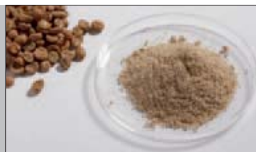
Сырой кофе перед измельчением и после измельчения в Р-14 с кольцевым ситом с 1 мм трапециевидной перфорацией при 20000 об/мин
