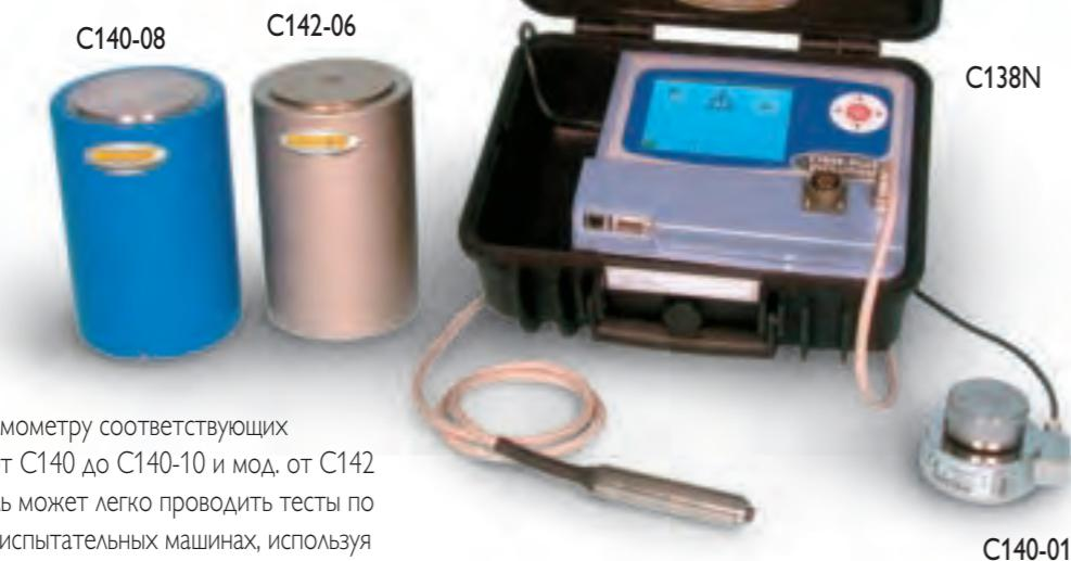
При подключении к динамометру соответствующих силоизмерителей (мод. от C140 до C140-10 и мод. от C142 до C142-08) пользователь может легко проводить тесты по проверке нагружения на испытательных машинах, используя цифровой дисплей с сенсорным экраном и интуитивно понятным интерфейсом.
