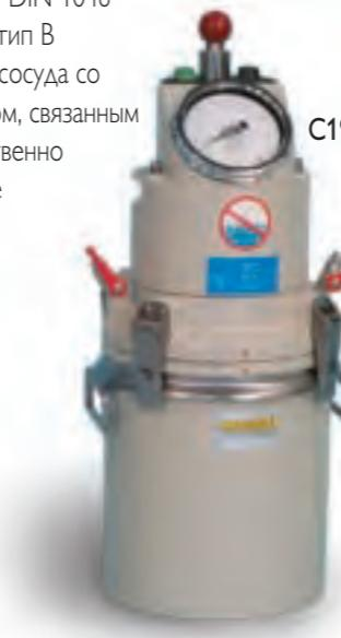
Изготовлен из алюминиевого сплава. Показывает процент воздуха, вовлеченного в свежезамешанный бетон, действуя по принципу давления воздуха. Поставляется в комплекте с манометром, штыковкой и ручным насосом.
