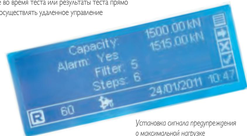
Установка сигнала предупреждения о максимальной нагрузке
