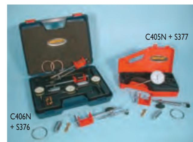
**ИЗМЕРИТЕЛИ ШИРИНЫ ТРЕЩИН**
