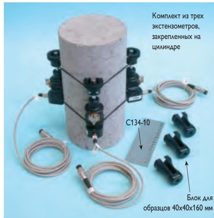
Комплект из трех экстензометров, закрепленных на цилиндре
