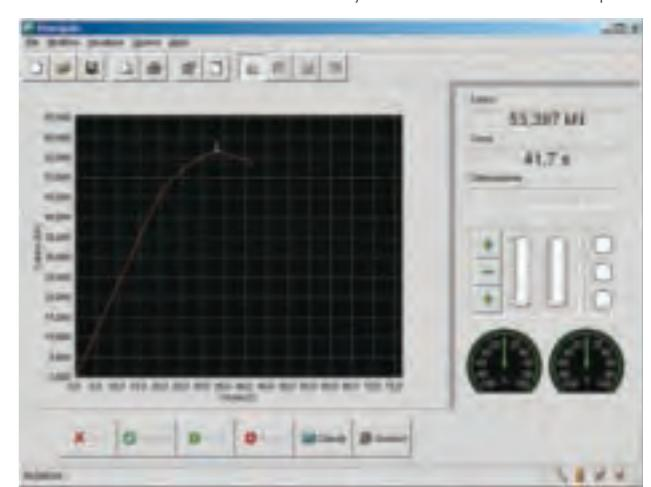
C109-12 График теста на растяжение при раскалывании
