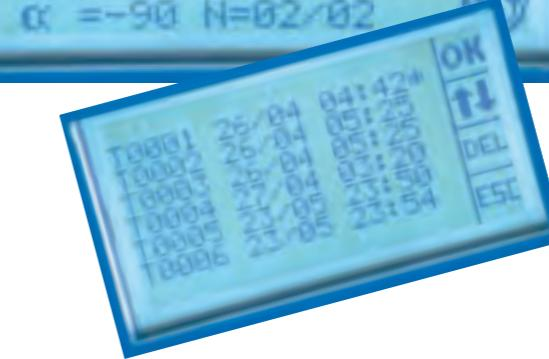
Цифровой склерометр Матест можно подключать к ультразвуковому "высокотехнологичному" тестеру мод. C372N (подробнее см. стр. 266) для комбинированного ультразвукового и ударного испытания с автоматическим сбором, хранением и обработкой результатов.
