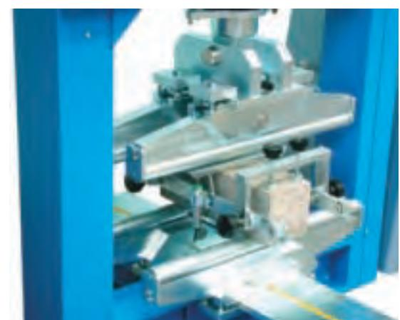
C090-15 на испытательной машине C090-07N
