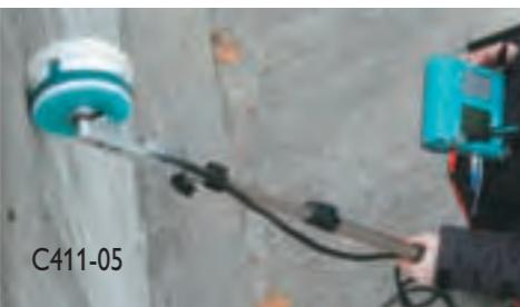
**C412-01****Измерение электропроводности бетона**
