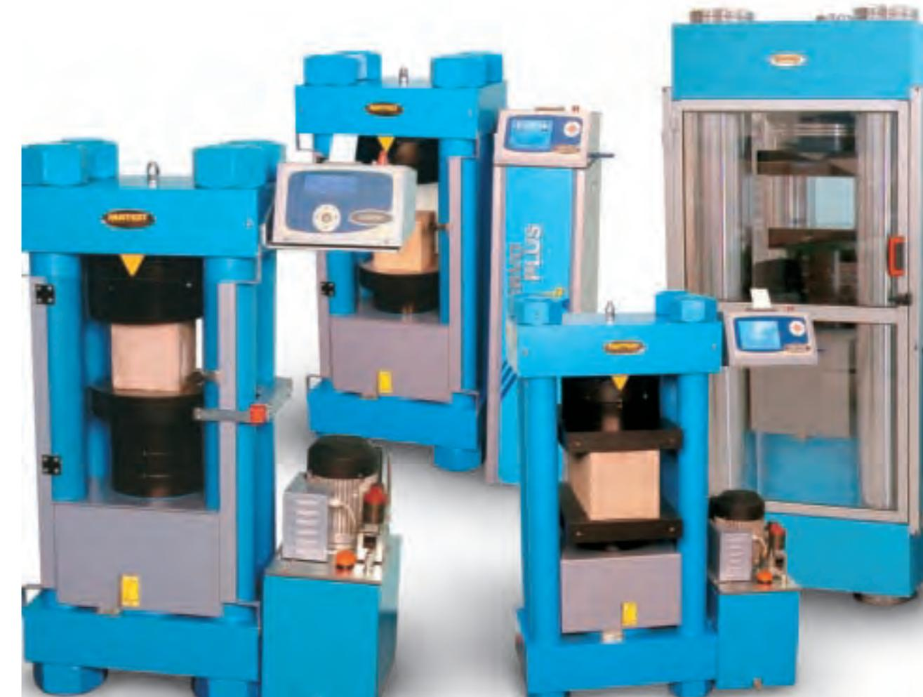
Возможные диапазоны: 2000 кН / 2000 кН для блоков / 3000 кН / 3000 кН для блоков / 5000 кН
