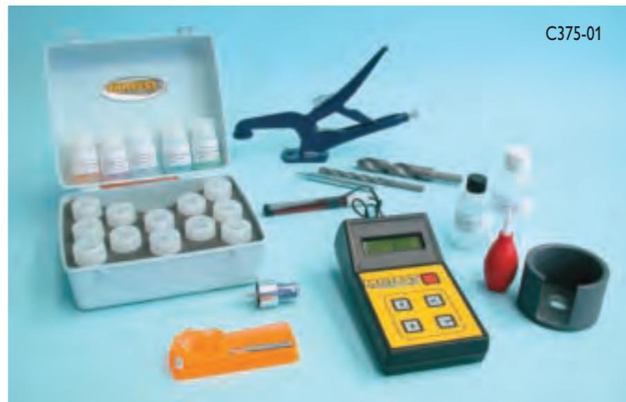
**C375-10 KIT****Воздухо- и водопроницаемость бетона**
