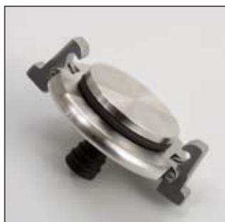
За счет фиксированного кольца круглого сечения в крышке размольные стаканы *premium line* закрываются настолько плотно, что возможно также совершенно беспрепятственное измельчение в суспензии без дополнительного уплотнения.
