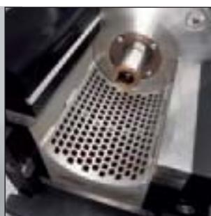
Большая глубина камеры измельчения для проб большого объема
