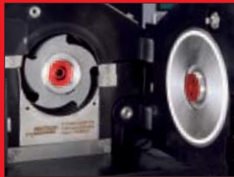
**Патент FRITSCH** В режущих мельницах FRITSCH P-19 и P-25 ротор установлен на двойных подшипниках с коническими роликами – на валу и в крышке. Это обеспечивает стабильный ход, минимальный износ и увеличенный срок службы Вашей мельницы. В модели P-15 ротор также установлен на двойных подшипниках.
