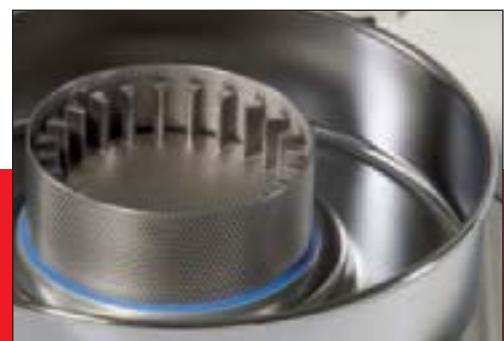
Особо гладкая поверхность ударных роторов из нержавеющей стали облегчает полную очистку – быстро и просто!
