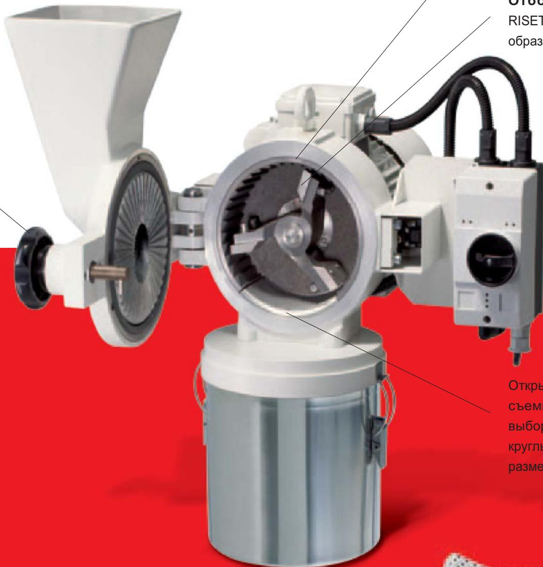
Открытая камера измельчения со съемным **вставным ситом**, на выбор с трапециoidalными или круглыми отверстиями различного размера.
