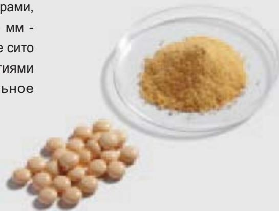
Таблетки перед измельчением и после измельчения в PULVERISETTE 14 с ударным кольцом и кольцевым ситом 2 мм с трапециoidalными отверстиями при 20000 об/мин
