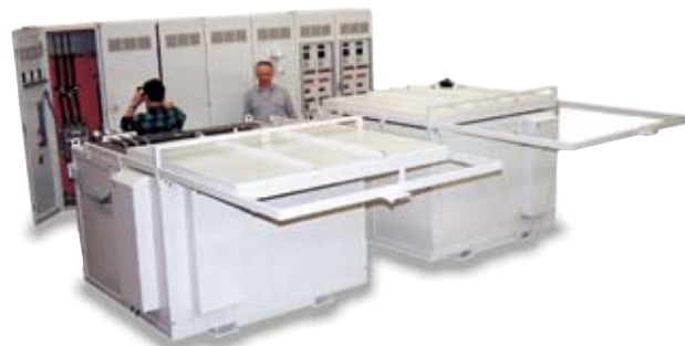
Установка с соляной ванной для отжига алюминиевых деталей в авиационной промышленности
