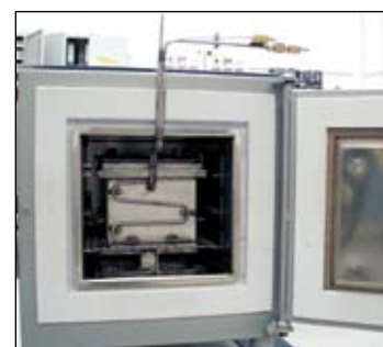
Печь с циркуляцией воздуха с ящиком подачи газа
